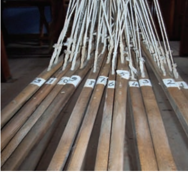
13 adet ayak/pedal ve üzerindeki deliklere bağlı çerçeve kumanda ipleri
